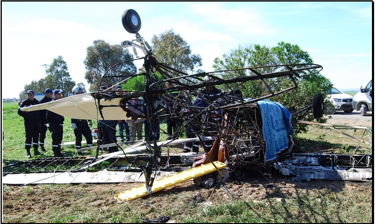
Avion renversé et toute sa partie arrière endommagée
