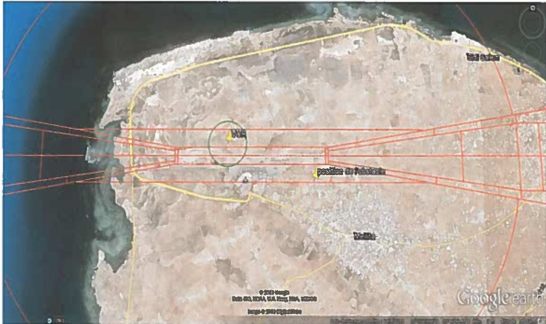
Figure 14 : cas d'un objet de trouvant dans la surface de transition
