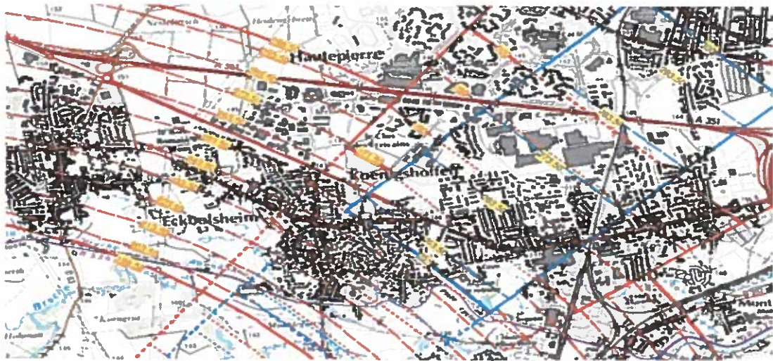
Figure 04 : Représentation des cotes altimétriques au niveau de la surface conique et des trouées
