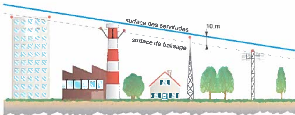
Figure 07- Surface de balisage des obstacles massifs et minces
